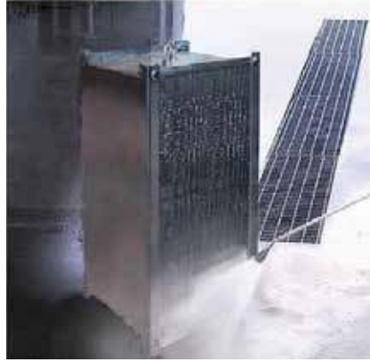
Adım 2: Basınçlı su ile temizlenir.
